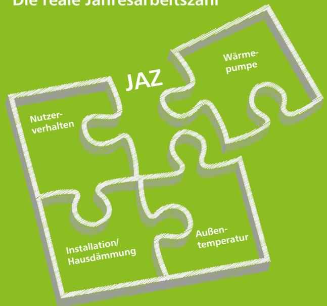
Die JAZ ist von vier Faktoren abhängig. Grundlage für die Berechnung der theoretischen JAZ für die Mitsubishi Electric Wärmepumpensysteme ist die VDI 4650, die Norm-Außentemperaturen, Vorlauftemperaturen, Spreizung und Heizgrenztemperatur zugrunde legt. So kann sich ein milderer Winter positiv auf die JAZ auswirken.
